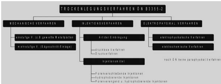
Abb 4: Übersicht der Trockenlegungsverfahren [Mück]
